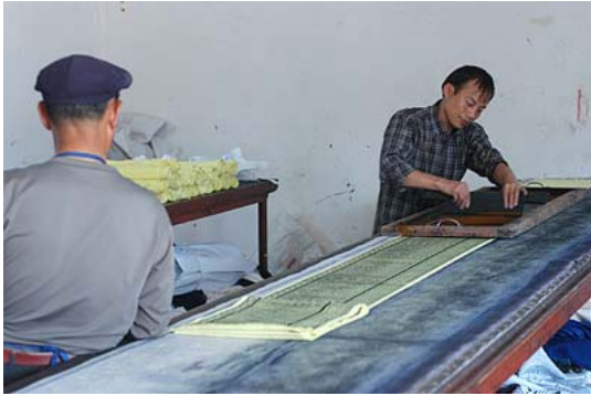
写真 13 シルク・スクリーンでプリントする
