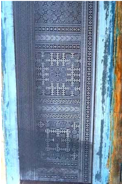
写真 14 シルク・スクリーンの孔板
